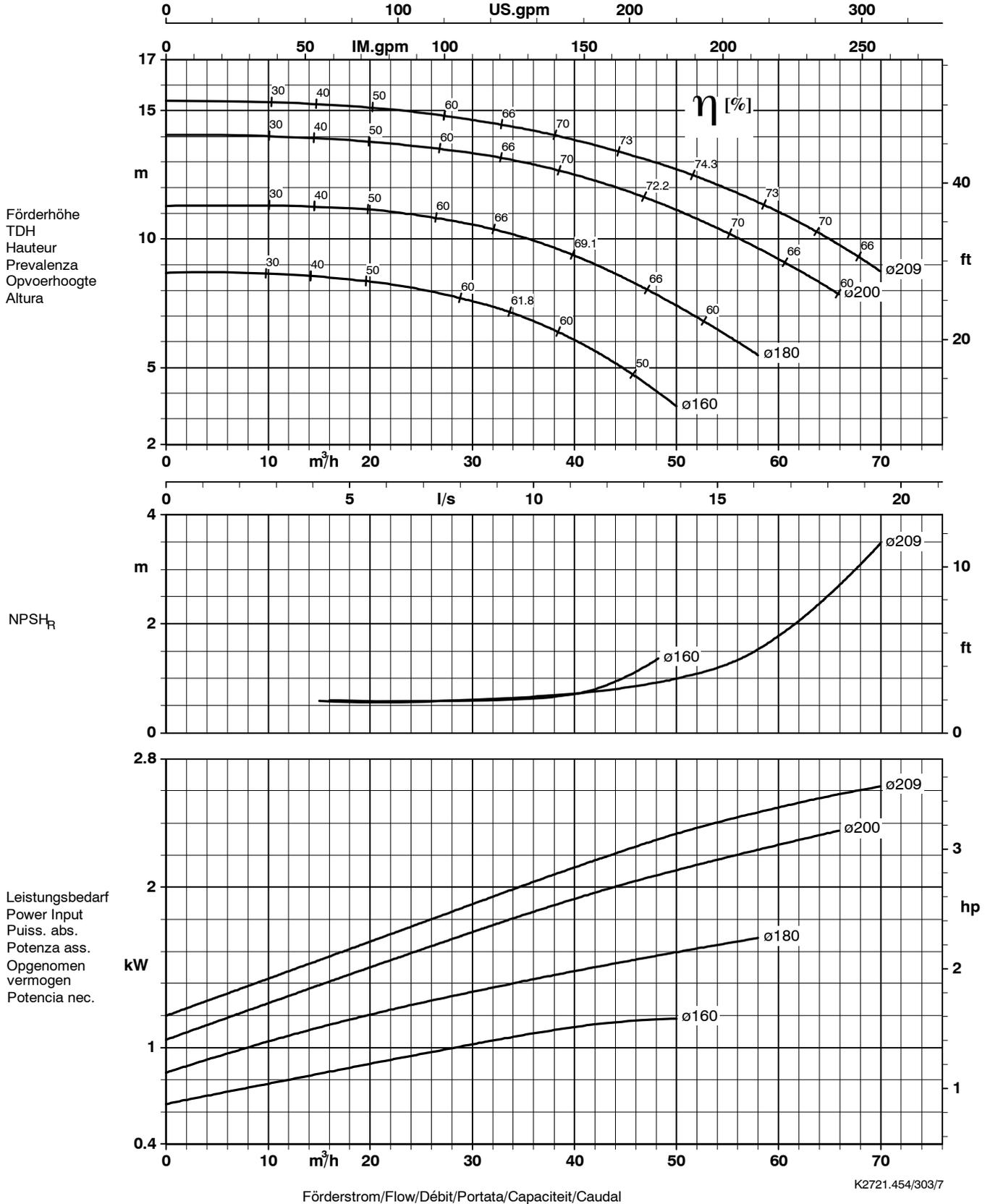
Lauftradaustrittsbreite/Impeller outlet width/Largeur à la sortie de la roue 16 mm
