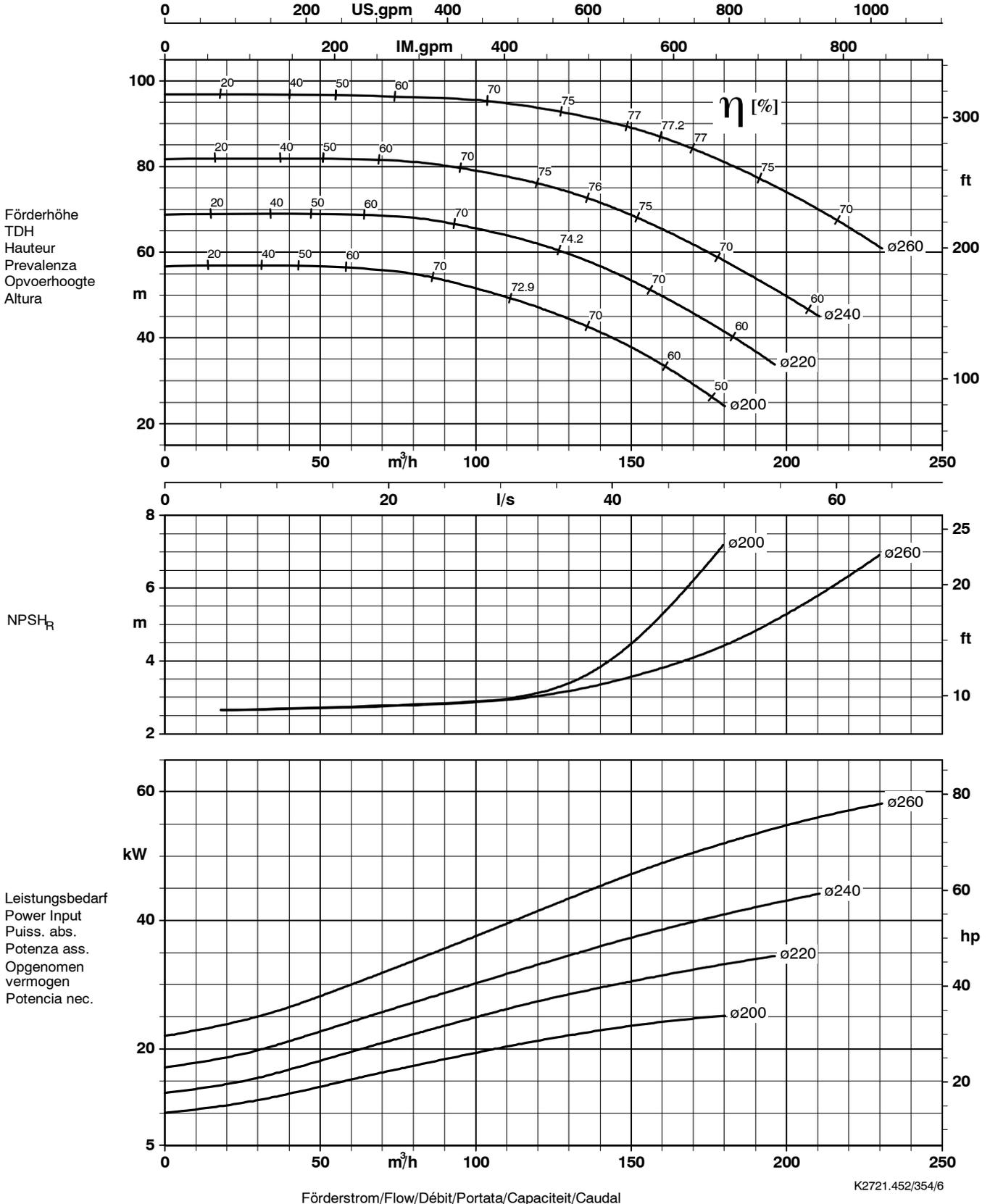
Lauftradaustrittsbreite/Impeller outlet width/Largeur à la sortie de la roue 17 mm
