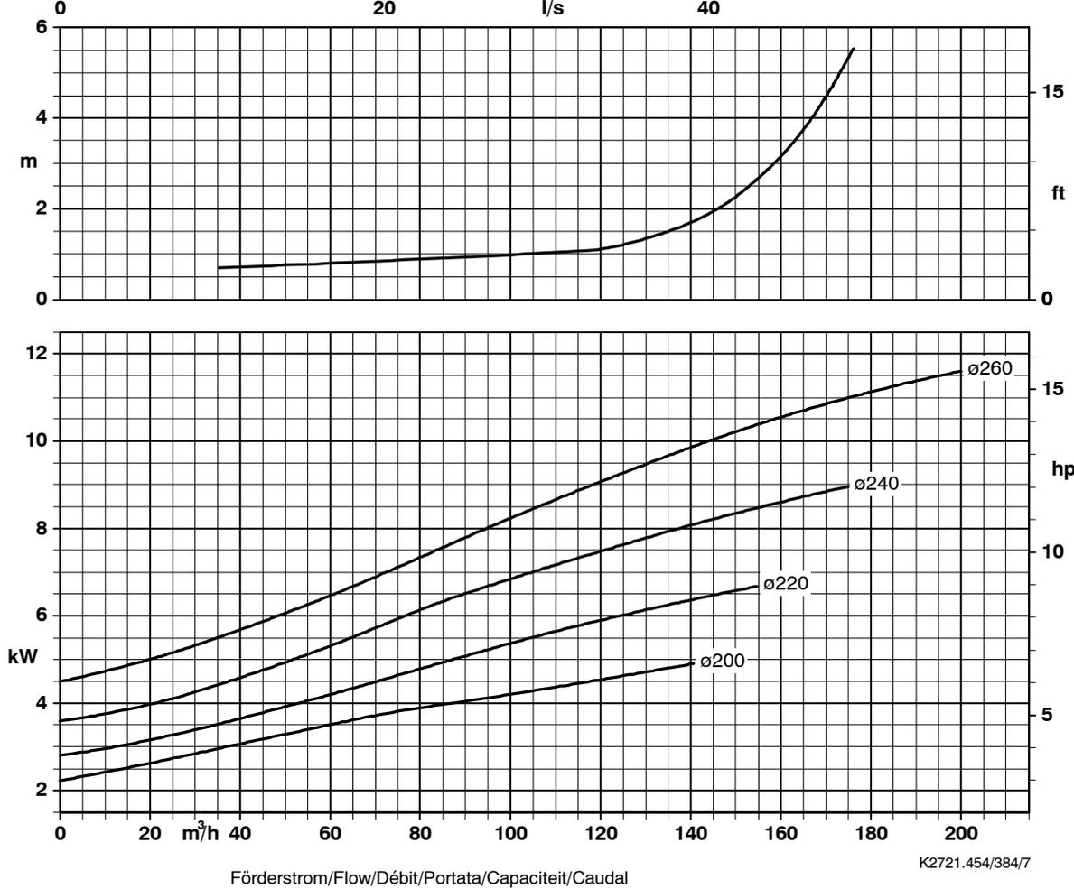
Laufraustrittsbreite/Impeller outlet width/Largeur à la sortie de la roue 23 mm
