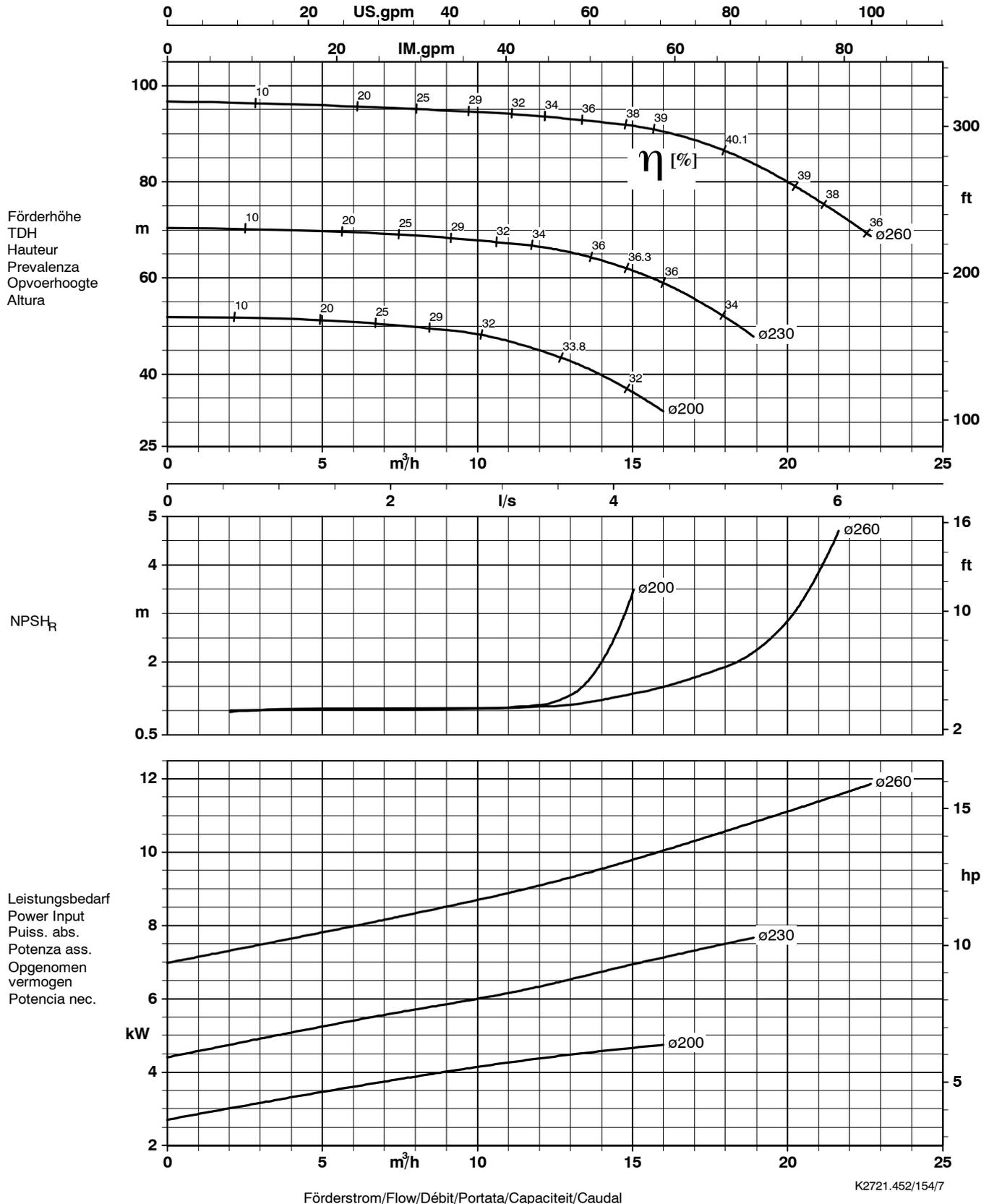
Laufraustrittsbreite/Impeller outlet width/Largeur à la sortie de la roue 6 mm
