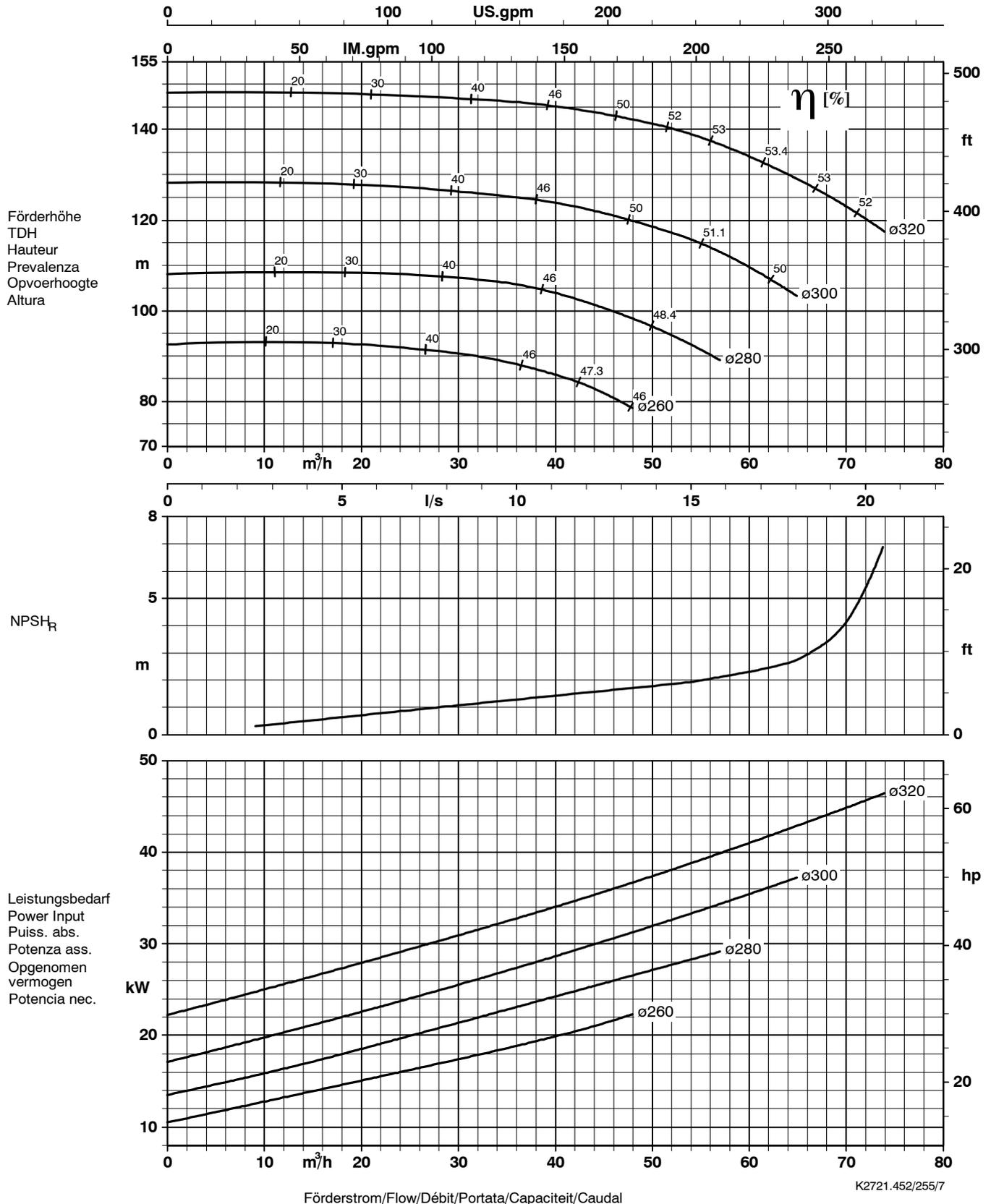
Laufraustrittsbreite/Impeller outlet width/Largeur à la sortie de la roue 8 mm
