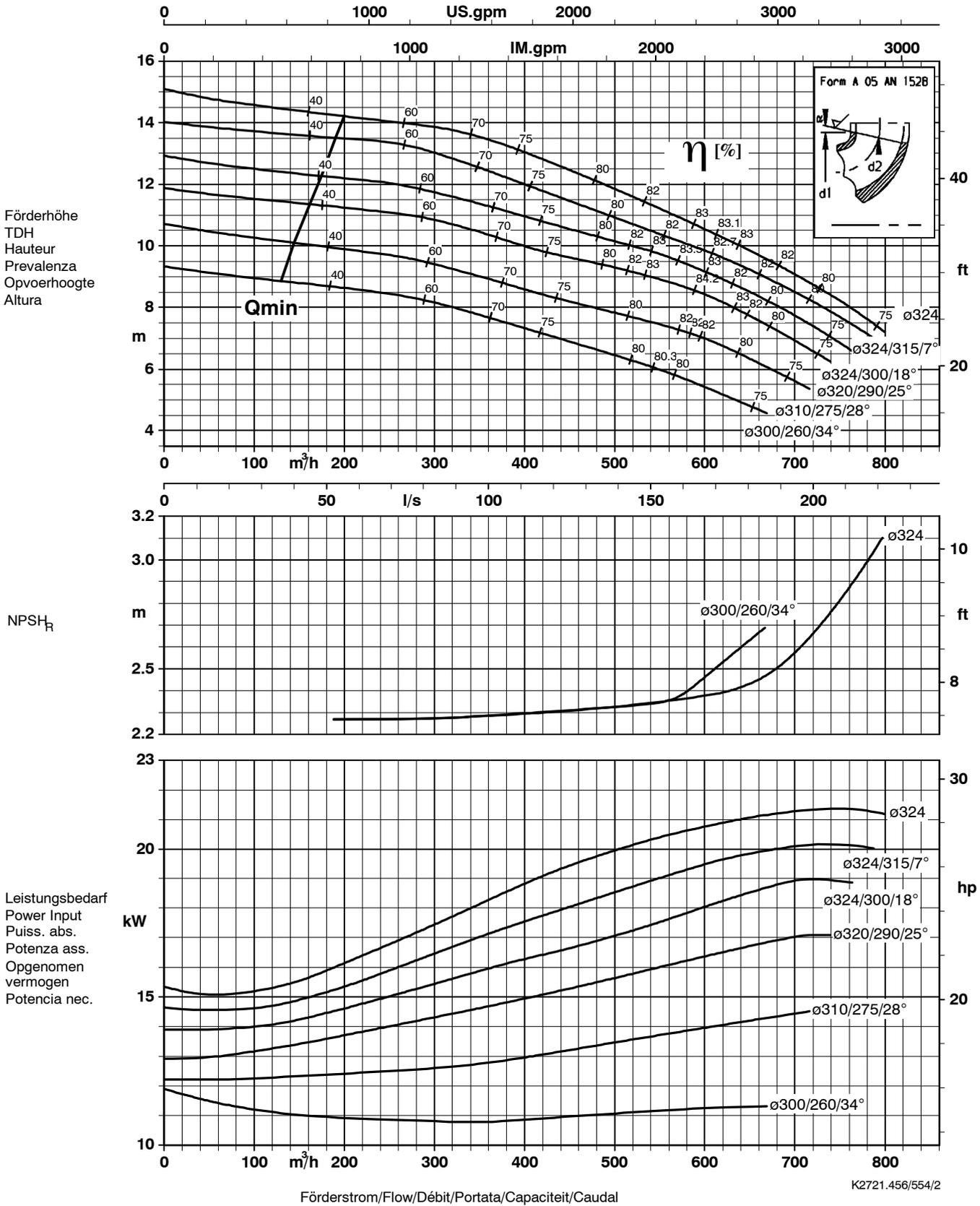
Laufraustrittsbreite/Impeller outlet width/Largeur à la sortie de la roue 73 mm
