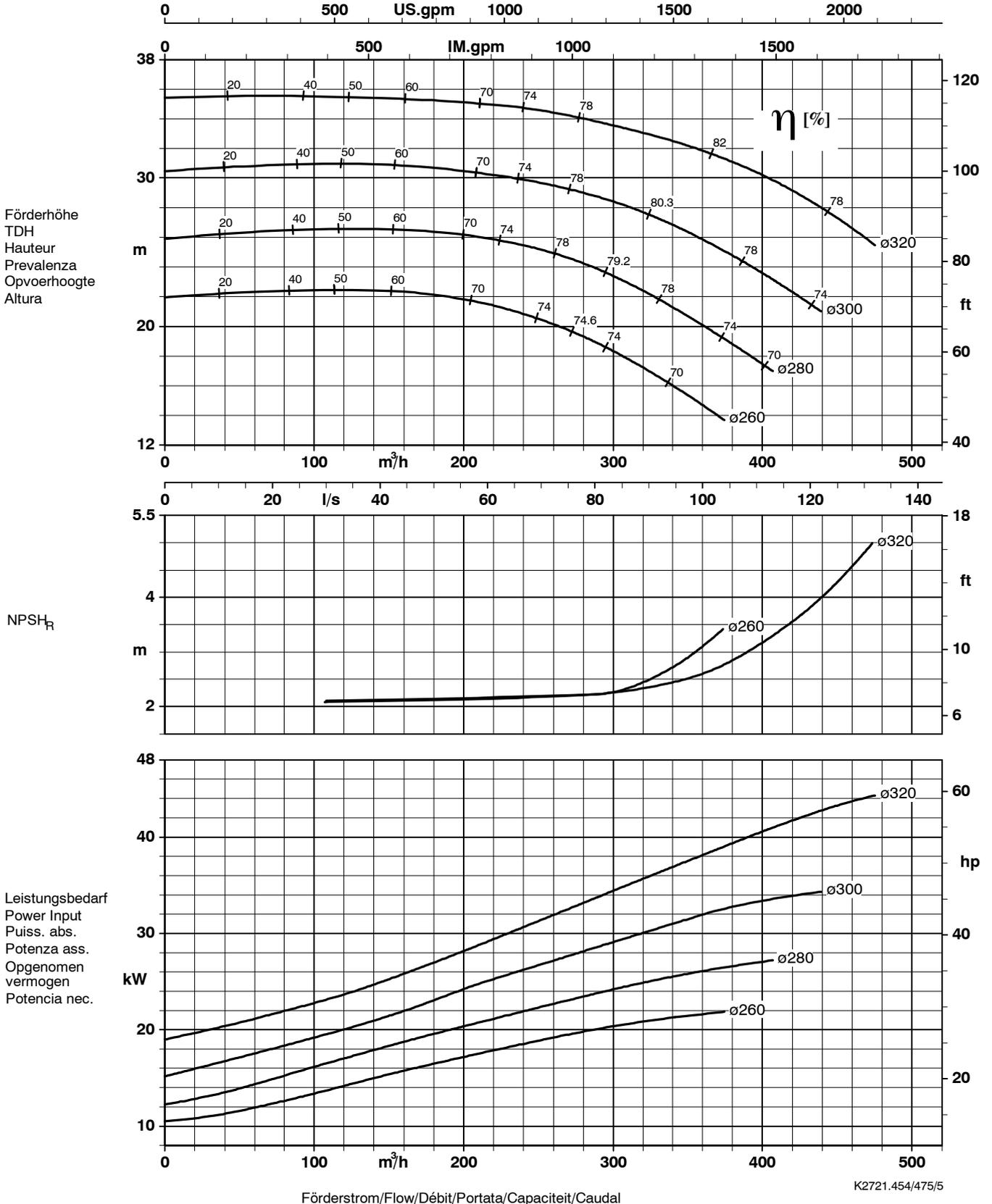
Laufradaustrittsbreite/Impeller outlet width/Largeur à la sortie de la roue 38 mm
