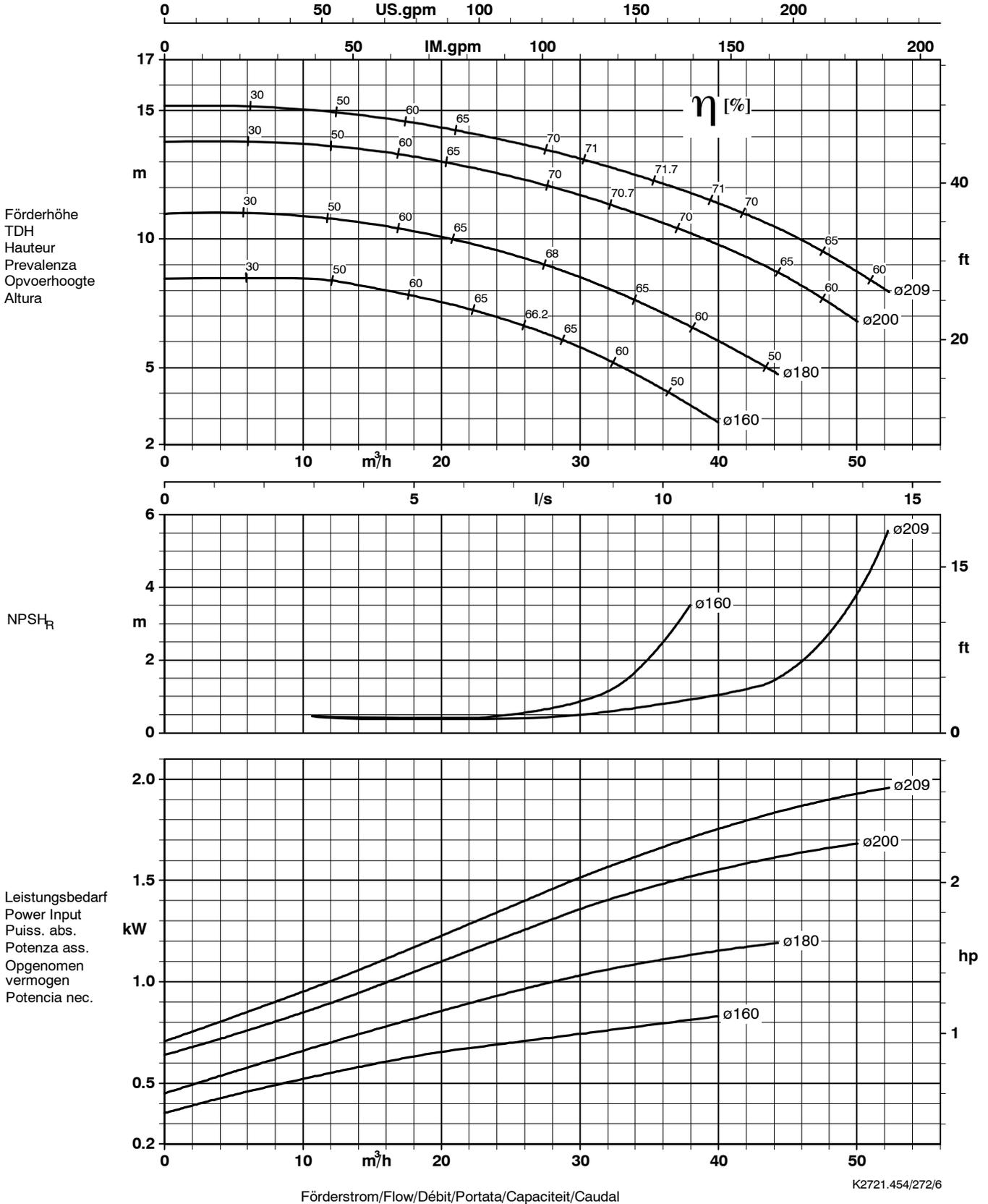
Lauftradaustrittsbreite/Impeller outlet width/Largeur à la sortie de la roue 12 mm
