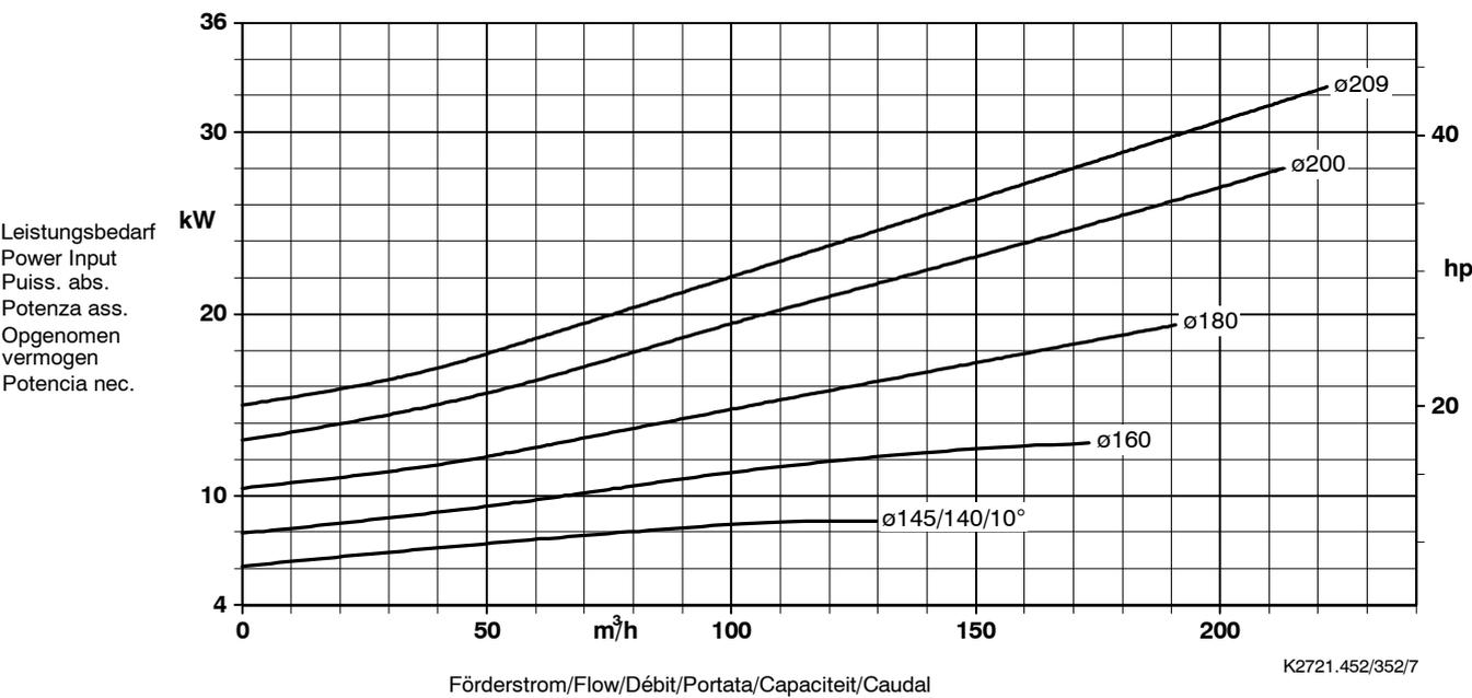
Laufradaustrittsbreite/Impeller outlet width/Largeur à la sortie de la roue 22 mm
