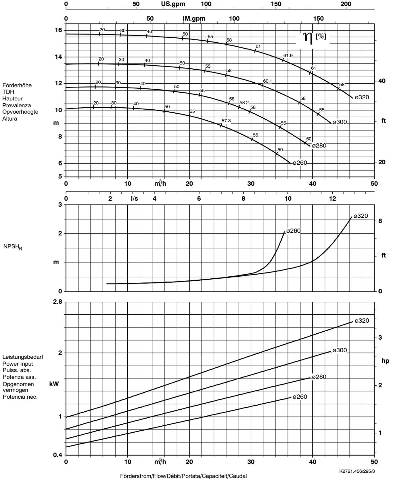
Laufradaustrittsbreite/Impeller outlet width/Largeur à la sortie de la roue 10 mm
