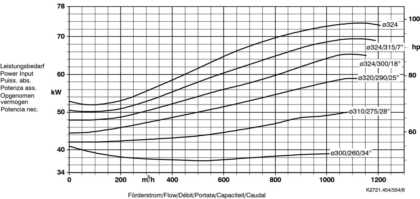
Laufradaustrittsbreite/Impeller outlet width/Largeur à la sortie de la roue 73 mm
