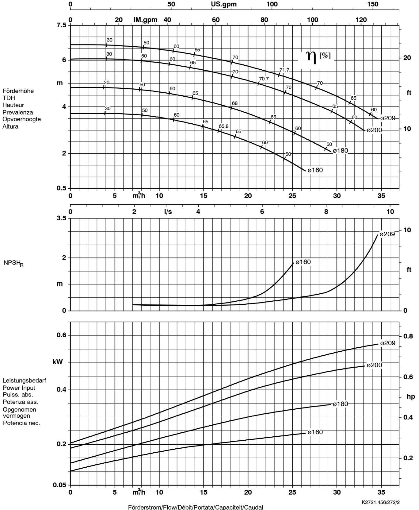
Laufradaustrittsbreite/Impeller outlet width/Largeur à la sortie de la roue 12 mm
