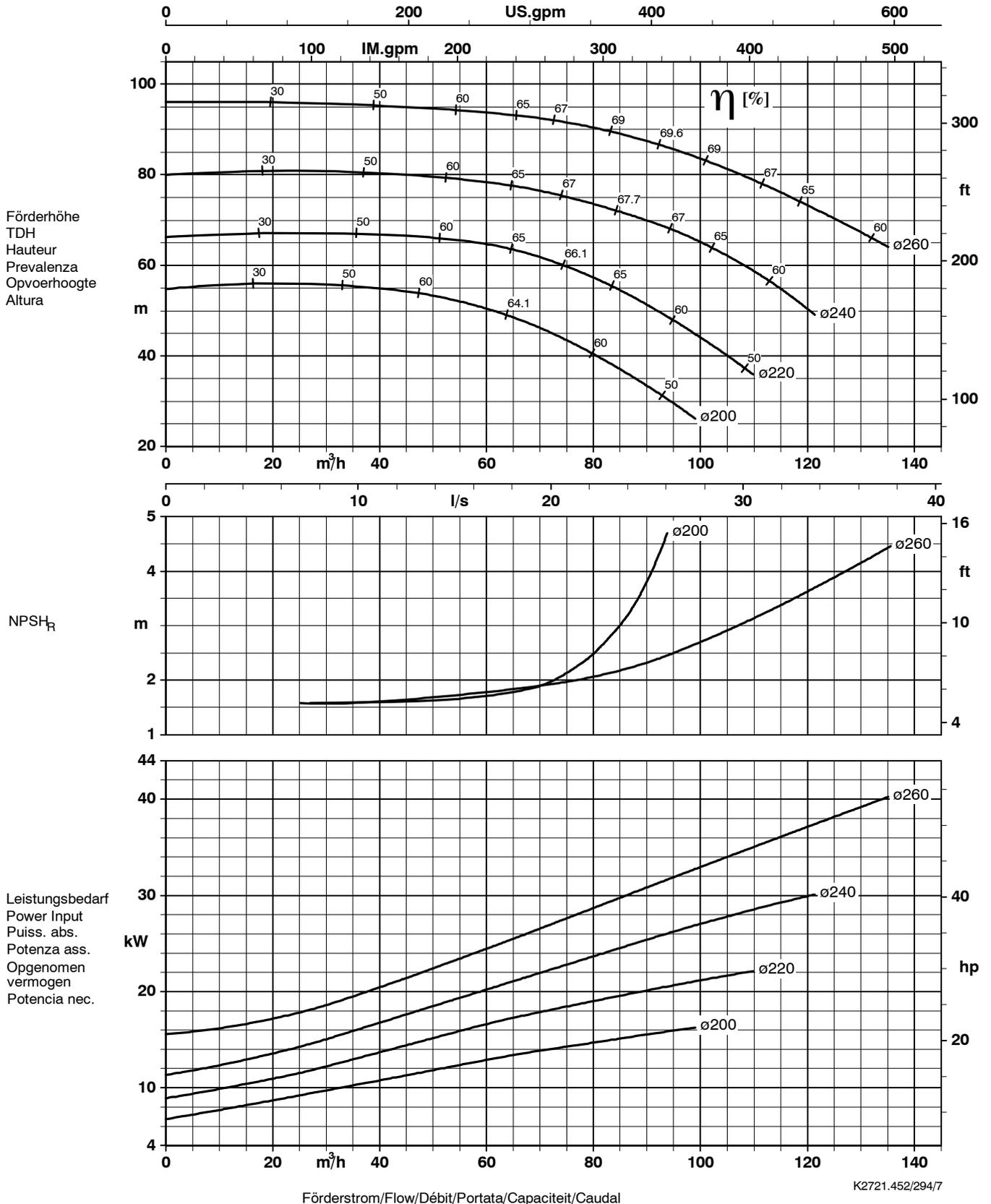
Laufradaustrittsbreite/Impeller outlet width/Largeur à la sortie de la roue 13 mm
