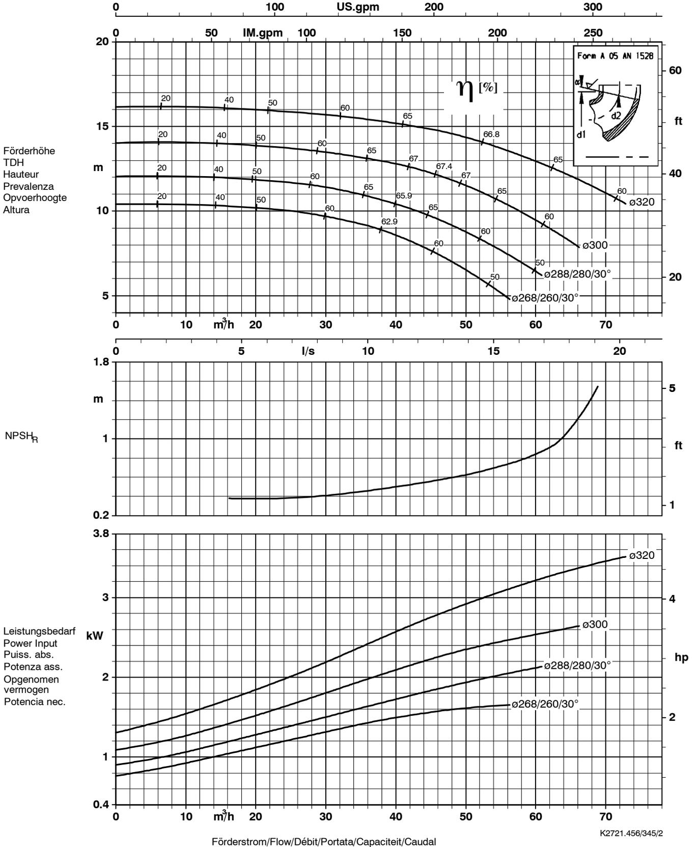
Laufradaustrittsbreite/Impeller outlet width/Largeur à la sortie de la roue 14 mm
