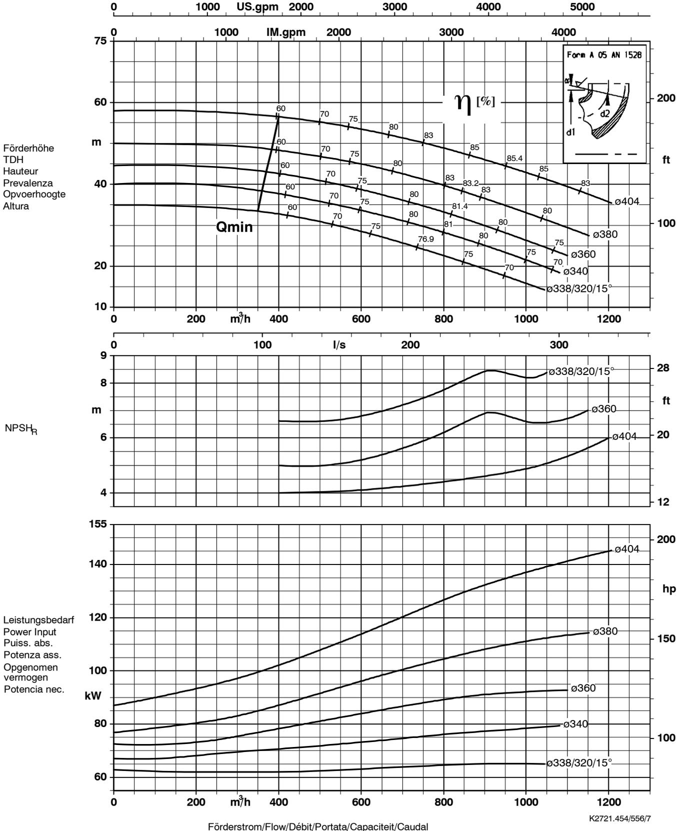
Laufradaustrittsbreite/Impeller outlet width/Largeur à la sortie de la roue 63 mm
