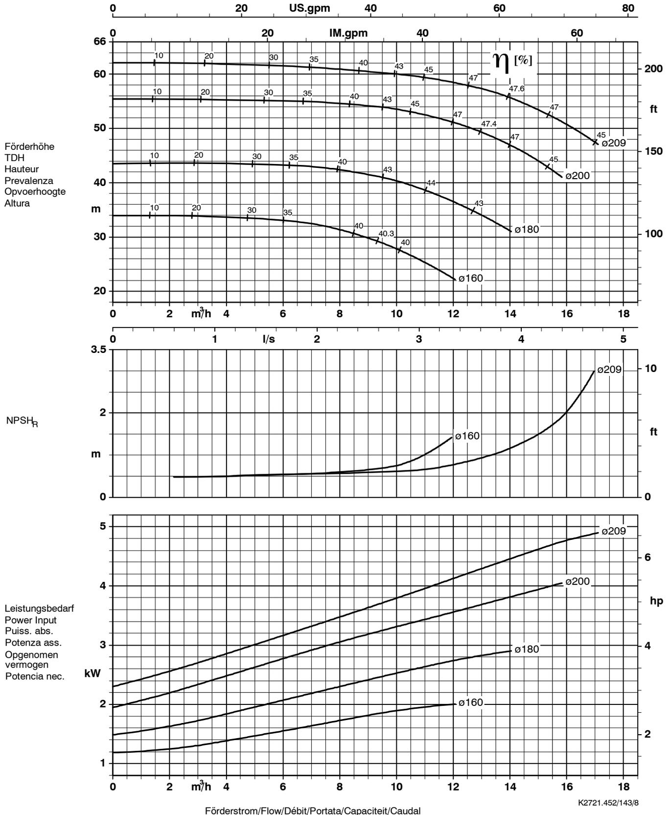
Laufradaustrittsbreite/Impeller outlet width/Largeur à la sortie de la roue 7 mm
