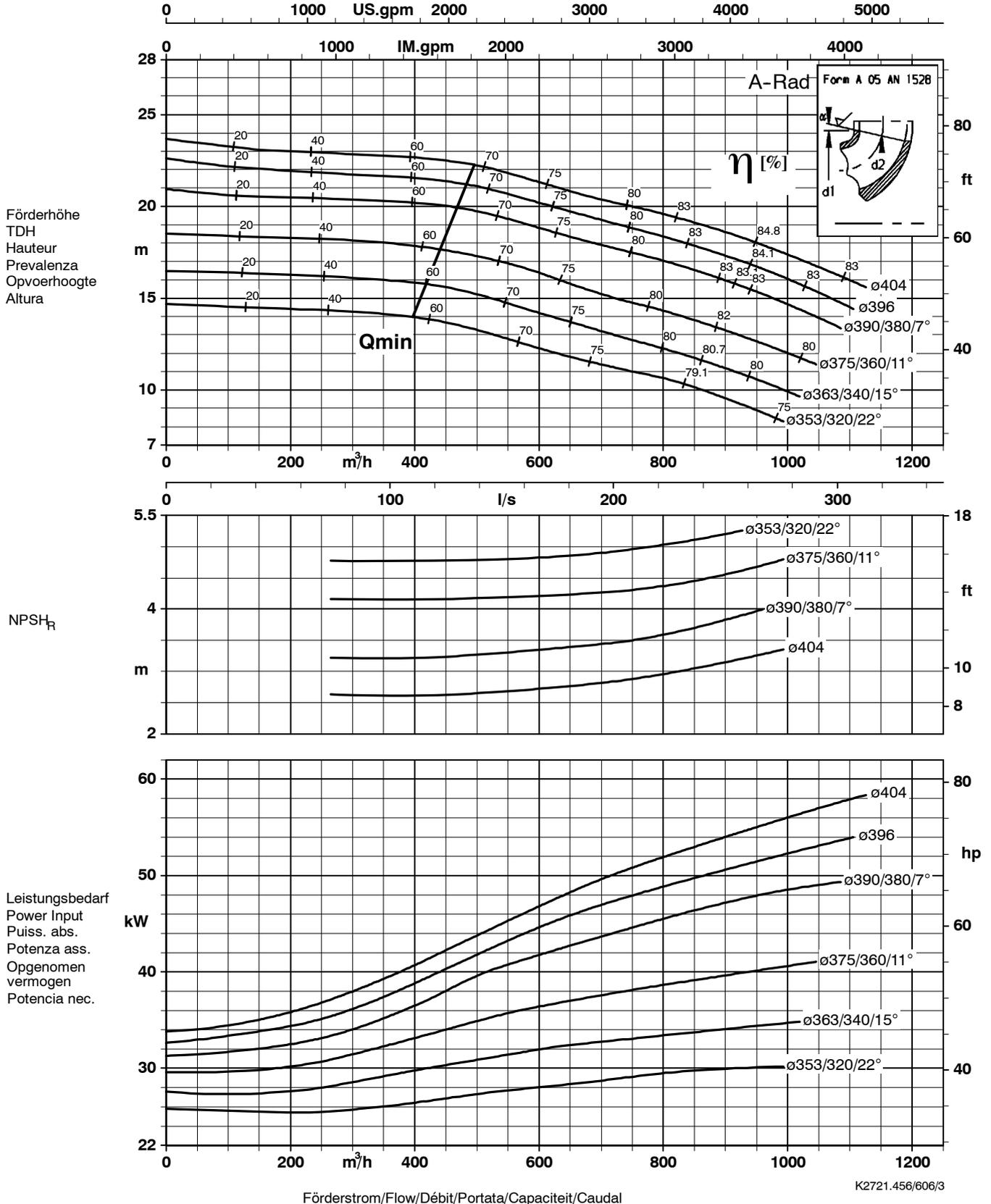
Lauftradaustrittsbreite/Impeller outlet width/Largeur à la sortie de la roue 68 mm
