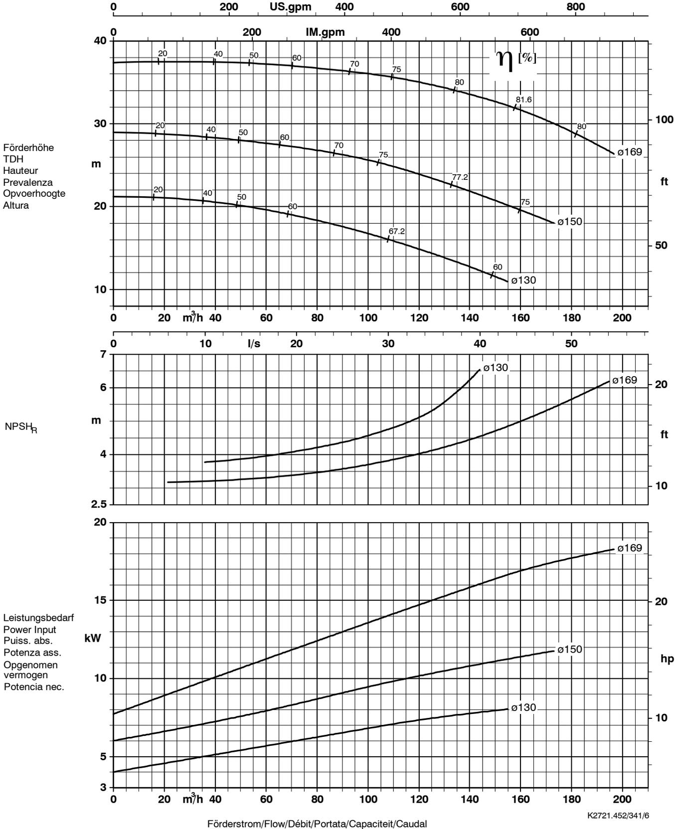
Laufradaustrittsbreite/Impeller outlet width/Largeur à la sortie de la roue 27 mm
