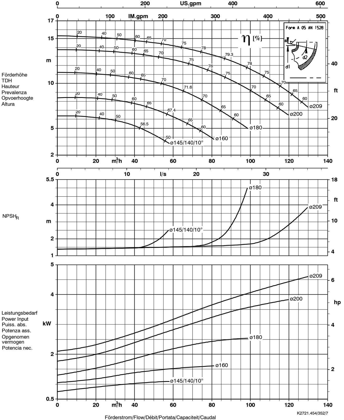
Lauftradaustrittsbreite/Impeller outlet width/Largeur à la sortie de la roue 22 mm
