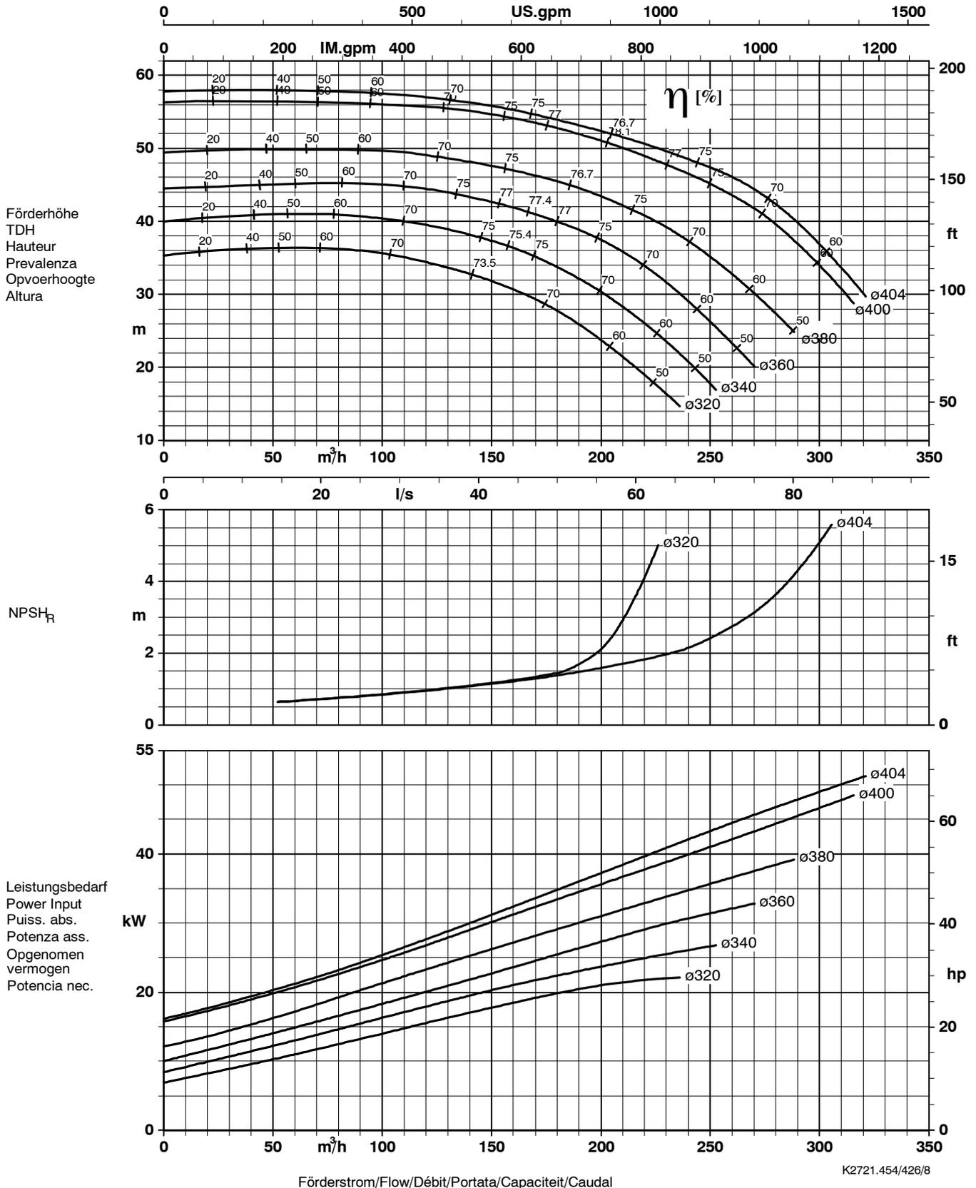
Laufradaustrittsbreite/Impeller outlet width/Largeur à la sortie de la roue 20 mm
