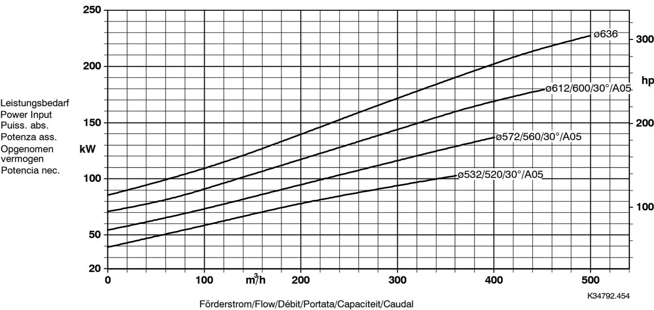
Laufraustrittsbreite/Impeller outlet width/Largeur à la sortie de la roue 21 mm
