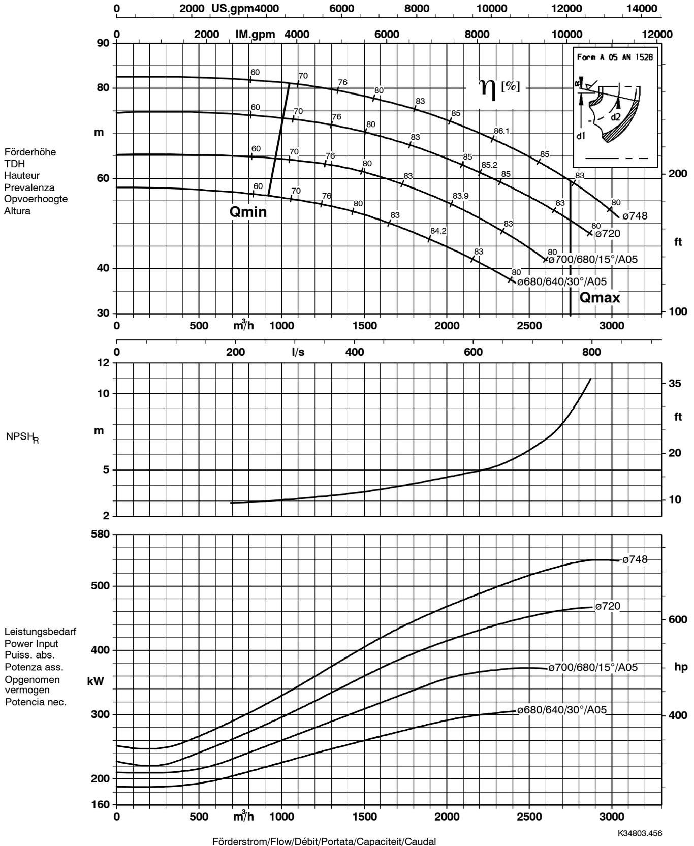
Lauf rad austrittsbreite/Impeller outlet width/Largeur à la sortie de la roue 72 mm
