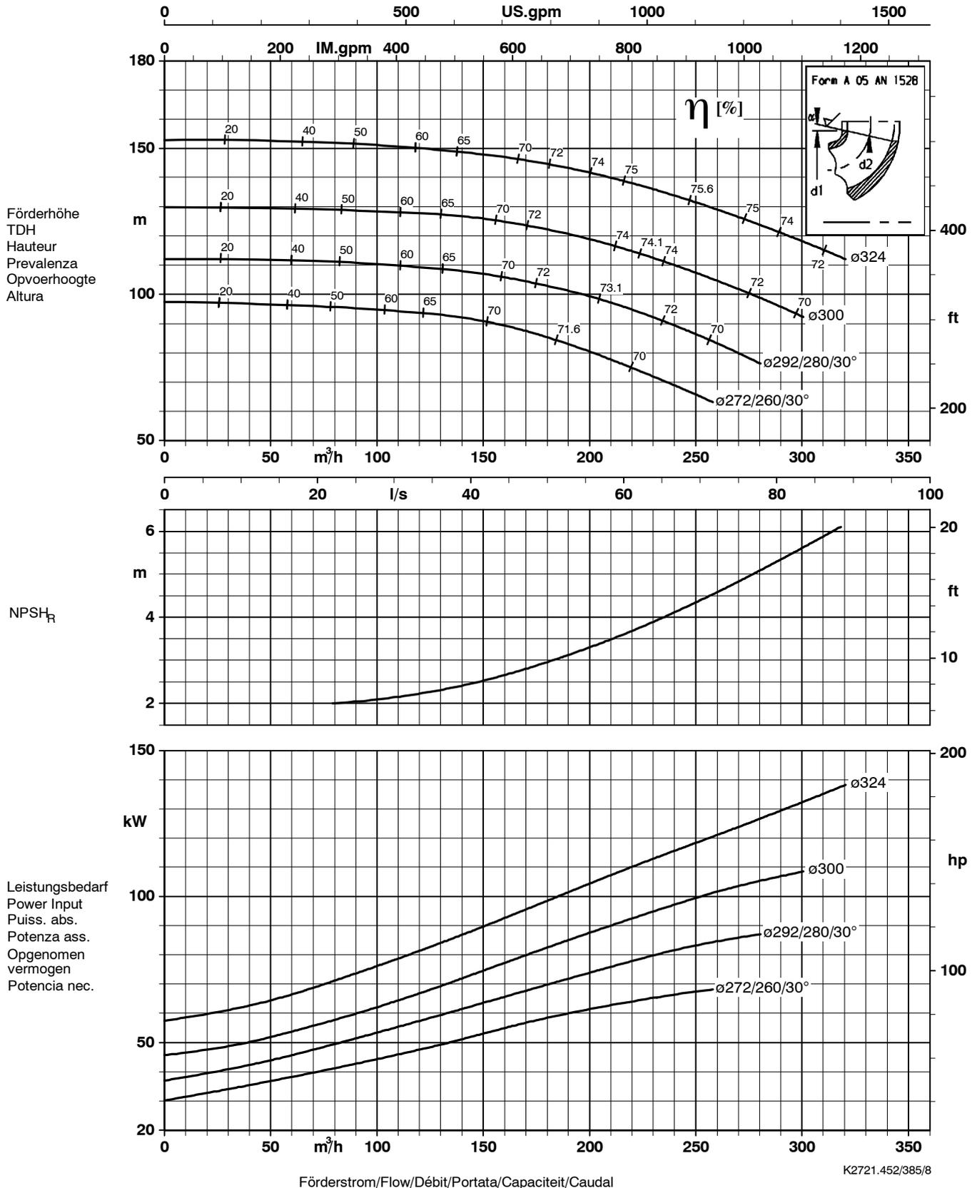
Laufradaustrittsbreite/Impeller outlet width/Largeur à la sortie de la roue 19,5 mm
