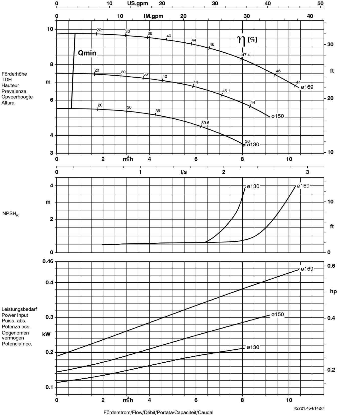
Lauftradaustrittsbreite/Impeller outlet width/Largeur à la sortie de la roue 7 mm
