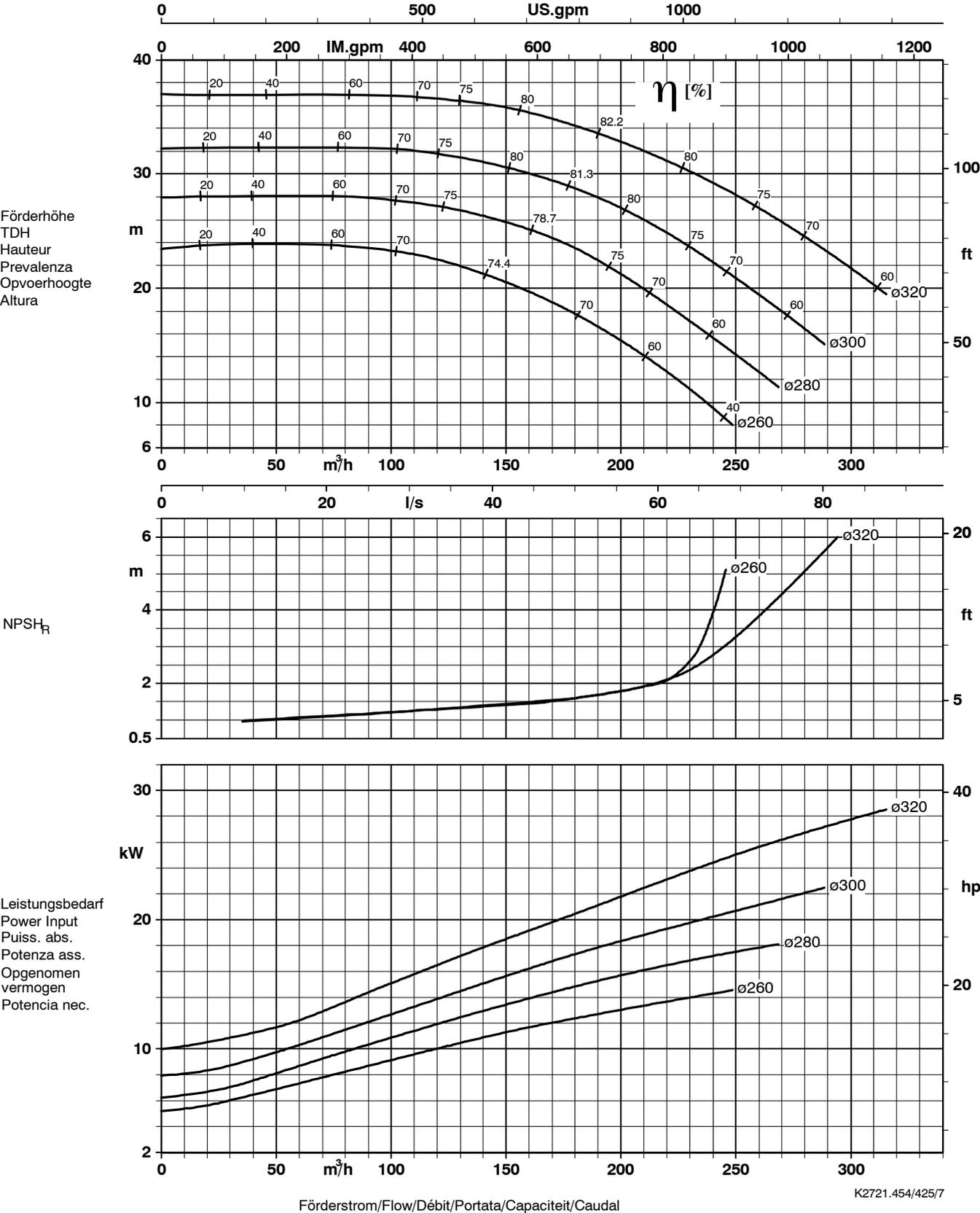
Laufraustrittsbreite/Impeller outlet width/Largeur à la sortie de la roue 26 mm
