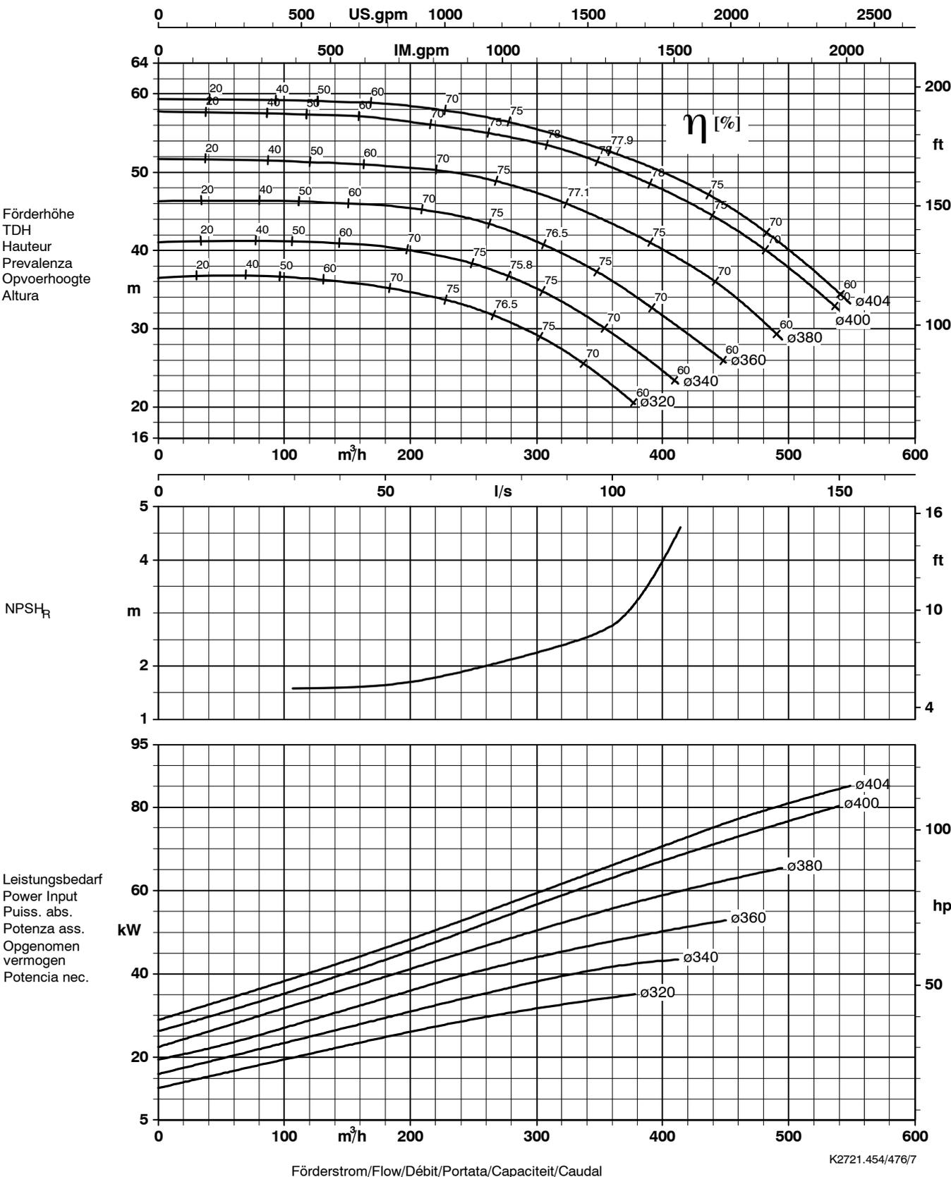
Lauf rad austrittsbreite / Impeller outlet width / Largeur à la sortie de la roue 29 mm
