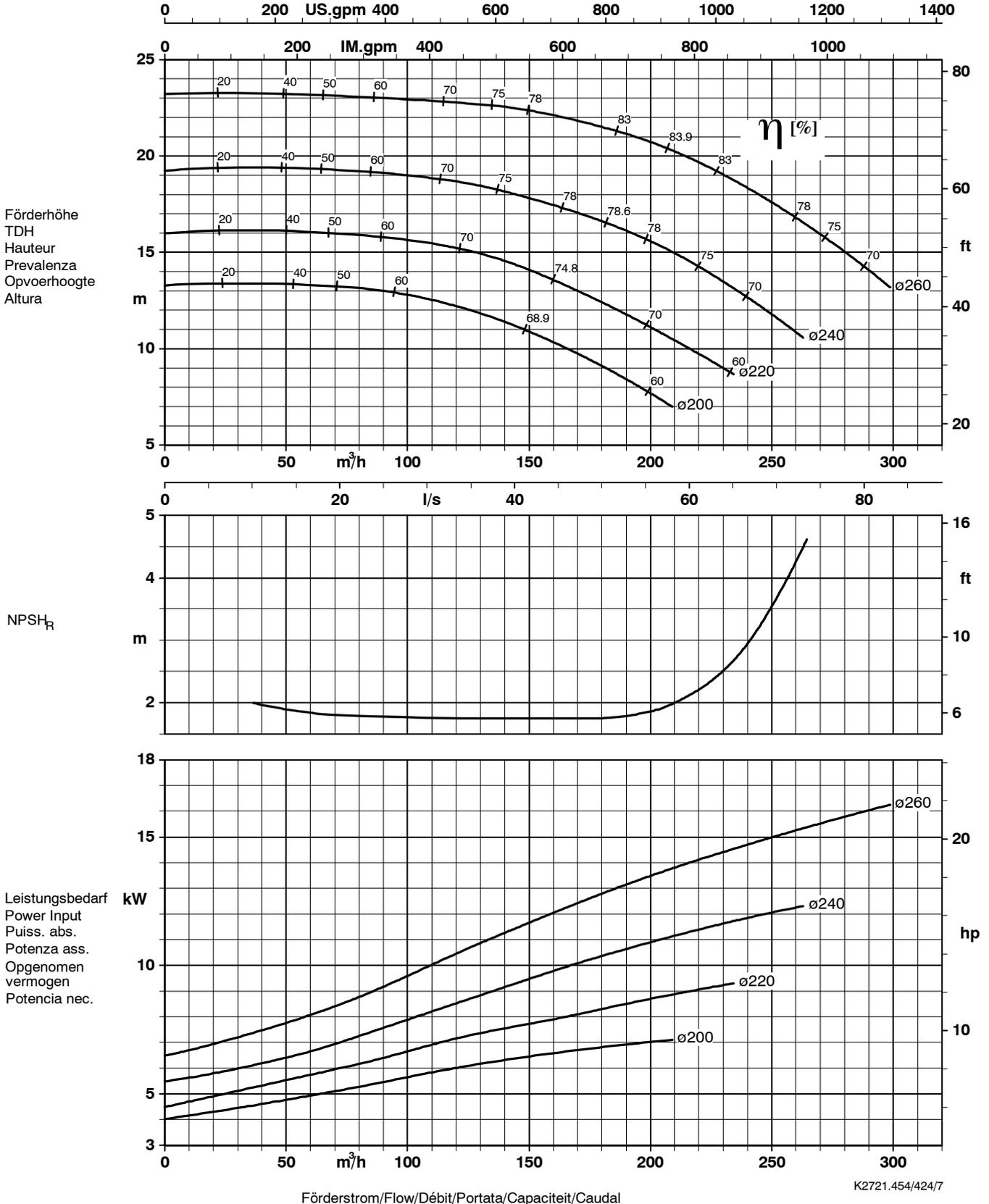
Laufradaustrittsbreite/Impeller outlet width/Largeur à la sortie de la roue 32 mm
