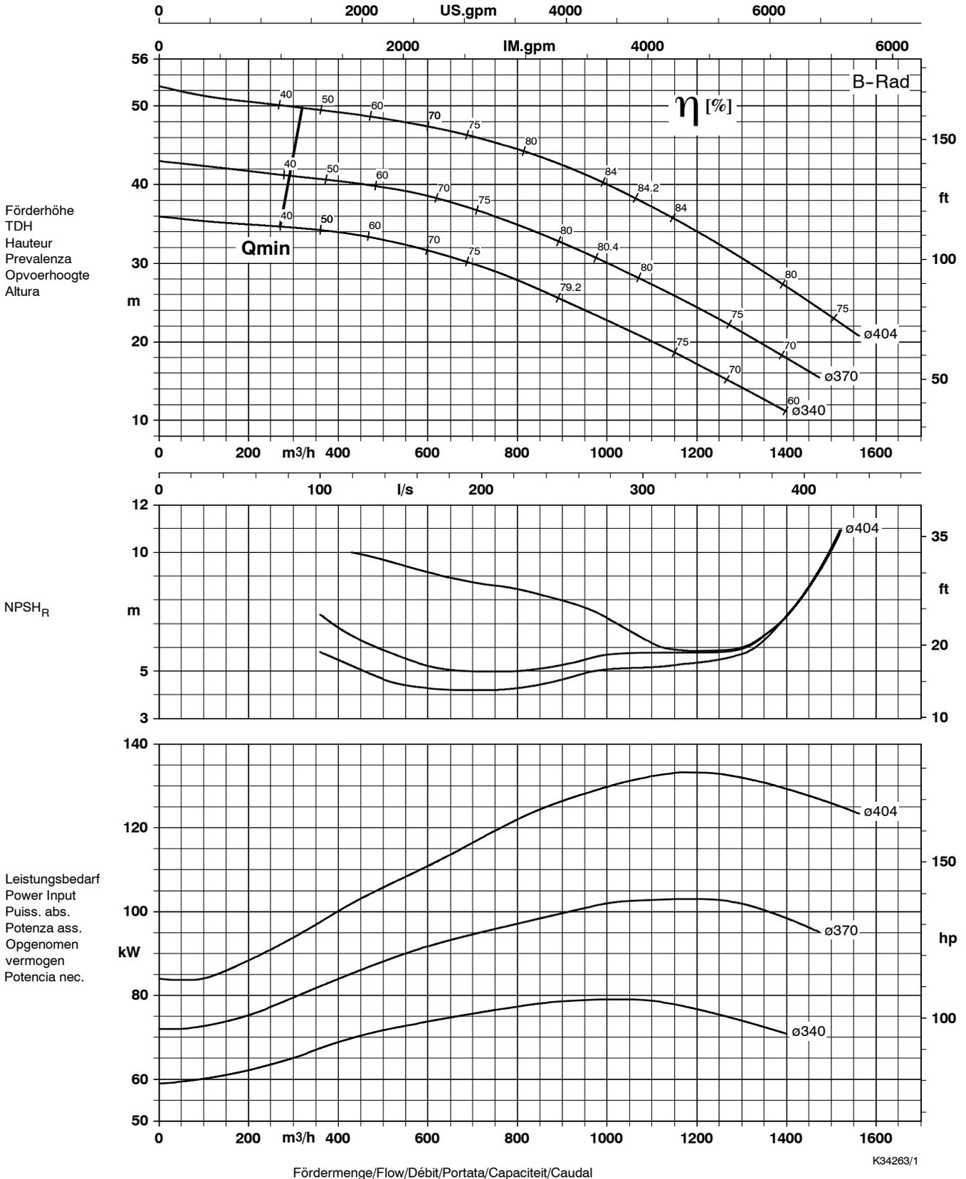
Lauf rad austrittsbreite / Impeller outlet width / Largeur à la sortie de la roue 59 mm
