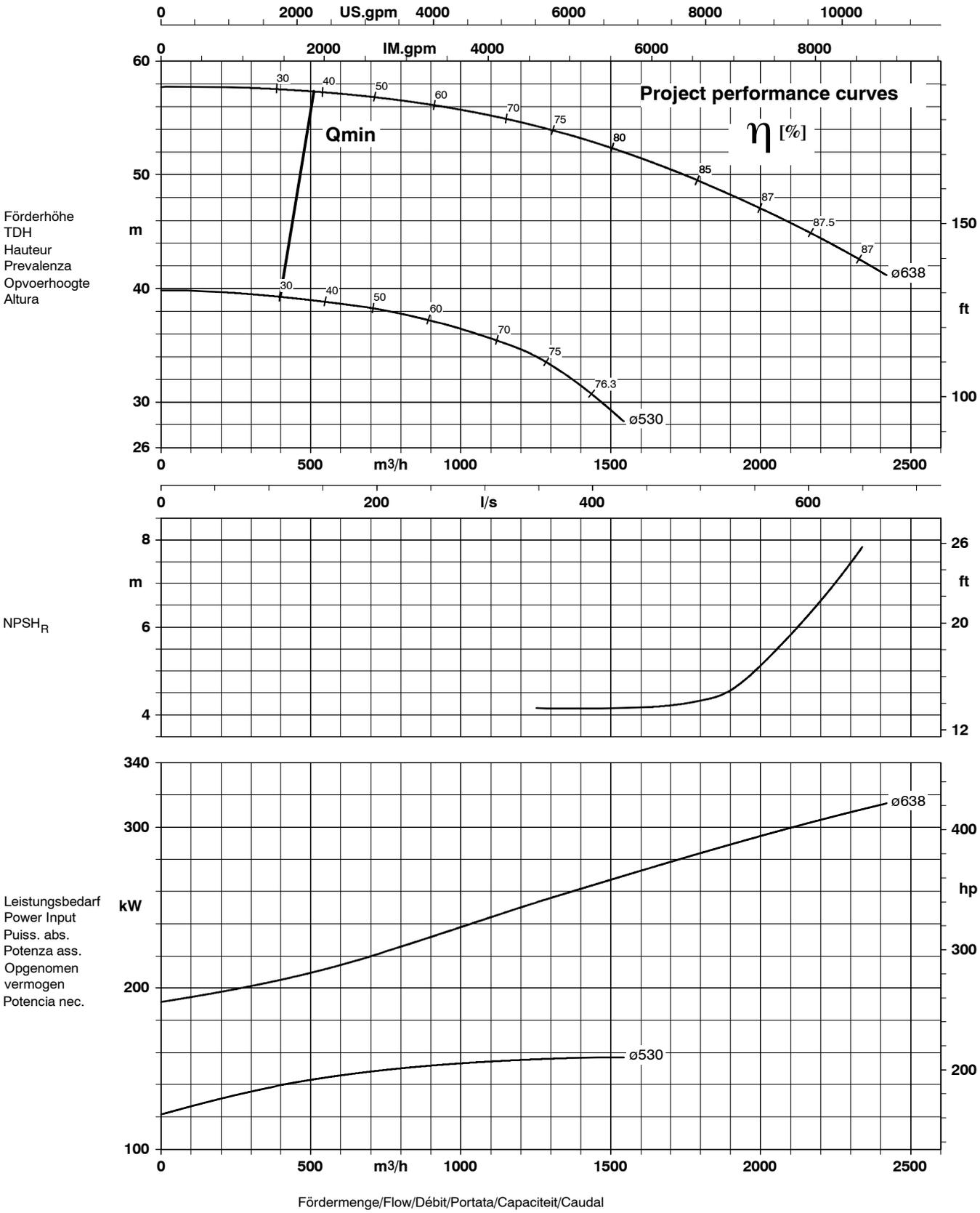
Lauf rad austrittsbreite / Impeller outlet width / Largeur à la sortie de la roue 68 mm
