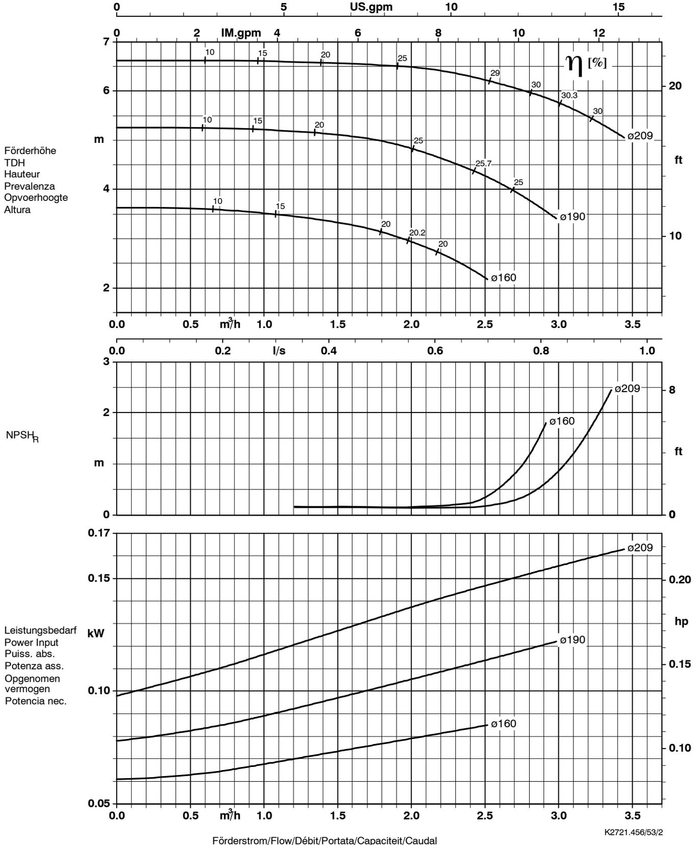
Lauftradaustrittsbreite/Impeller outlet width/Largeur à la sortie de la roue 6 mm
