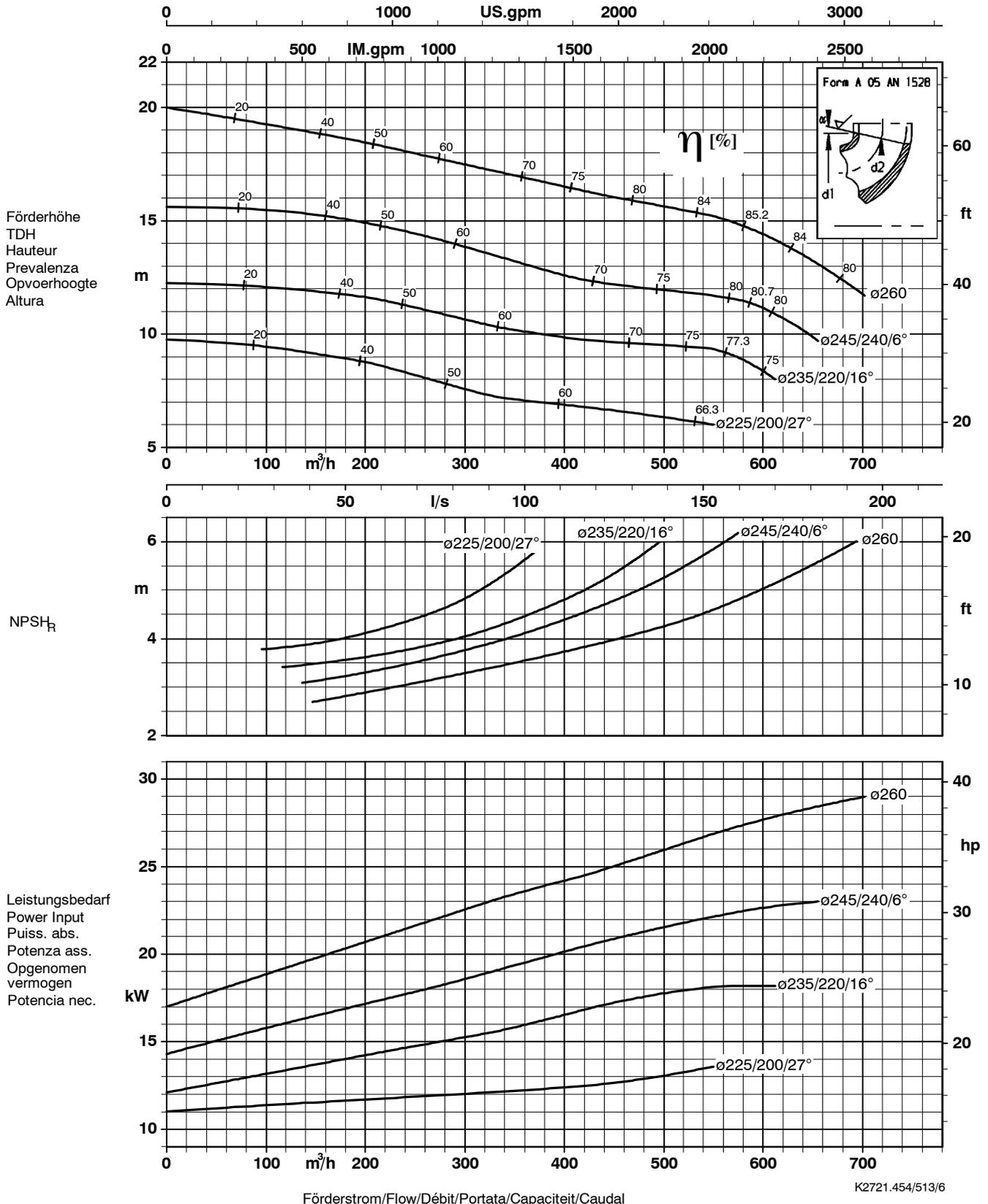
Laufradaustrittsbreite/Impeller outlet width/Largeur à la sortie de la roue 62 mm
