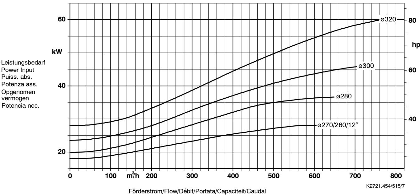
Lauf rad austrittsbreite / Impeller outlet width / Largeur à la sortie de la roue 50 mm
