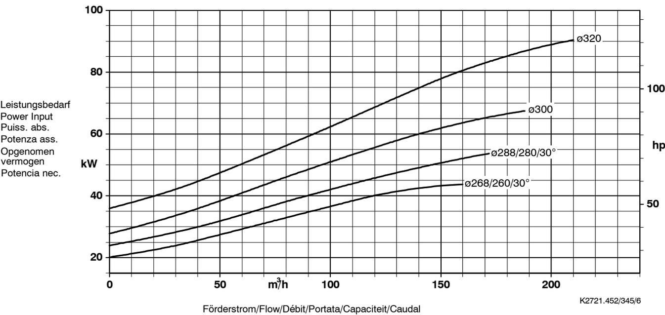
Laufradaustrittsbreite/Impeller outlet width/Largeur à la sortie de la roue 14 mm
