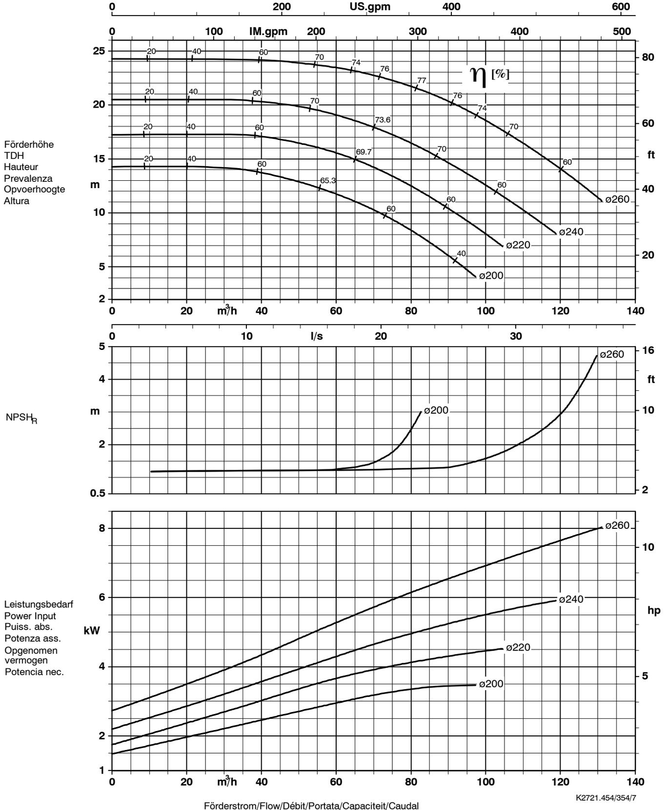
Laufraustrittsbreite/Impeller outlet width/Largeur à la sortie de la roue 17 mm
