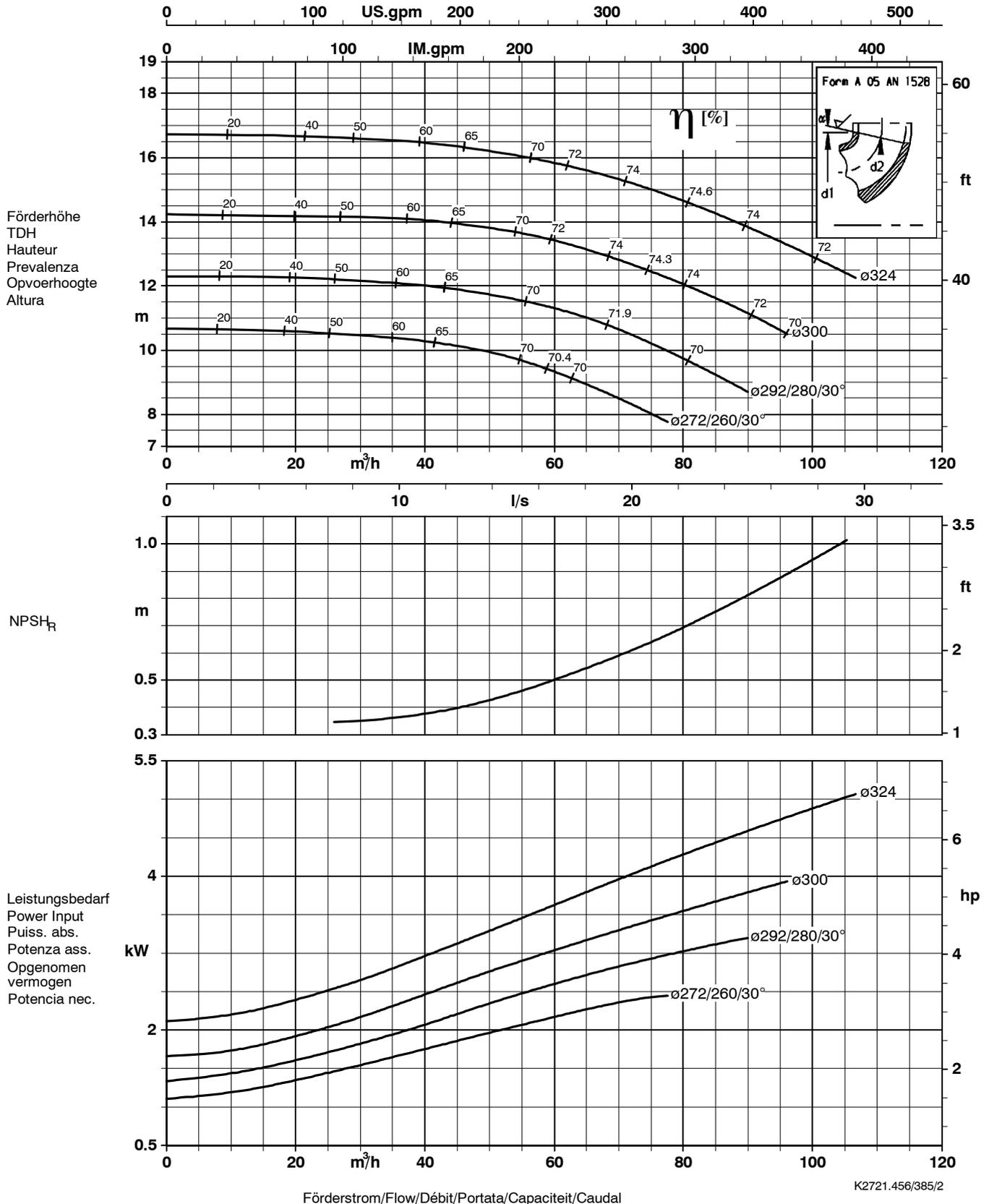
Lauftradaustrittsbreite/Impeller outlet width/Largeur à la sortie de la roue 19,5 mm
