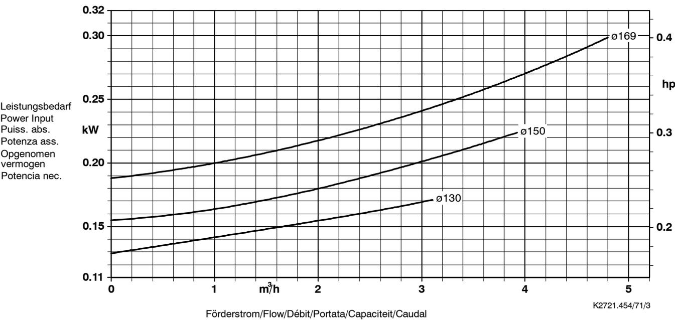
Laufradaustrittsbreite/Impeller outlet width/Largeur à la sortie de la roue 6 mm
