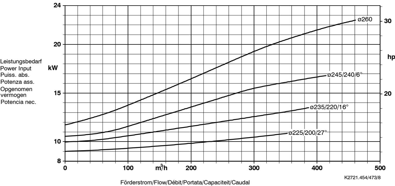
Laufradaustrittsbreite/Impeller outlet width/Largeur à la sortie de la roue 46 mm
