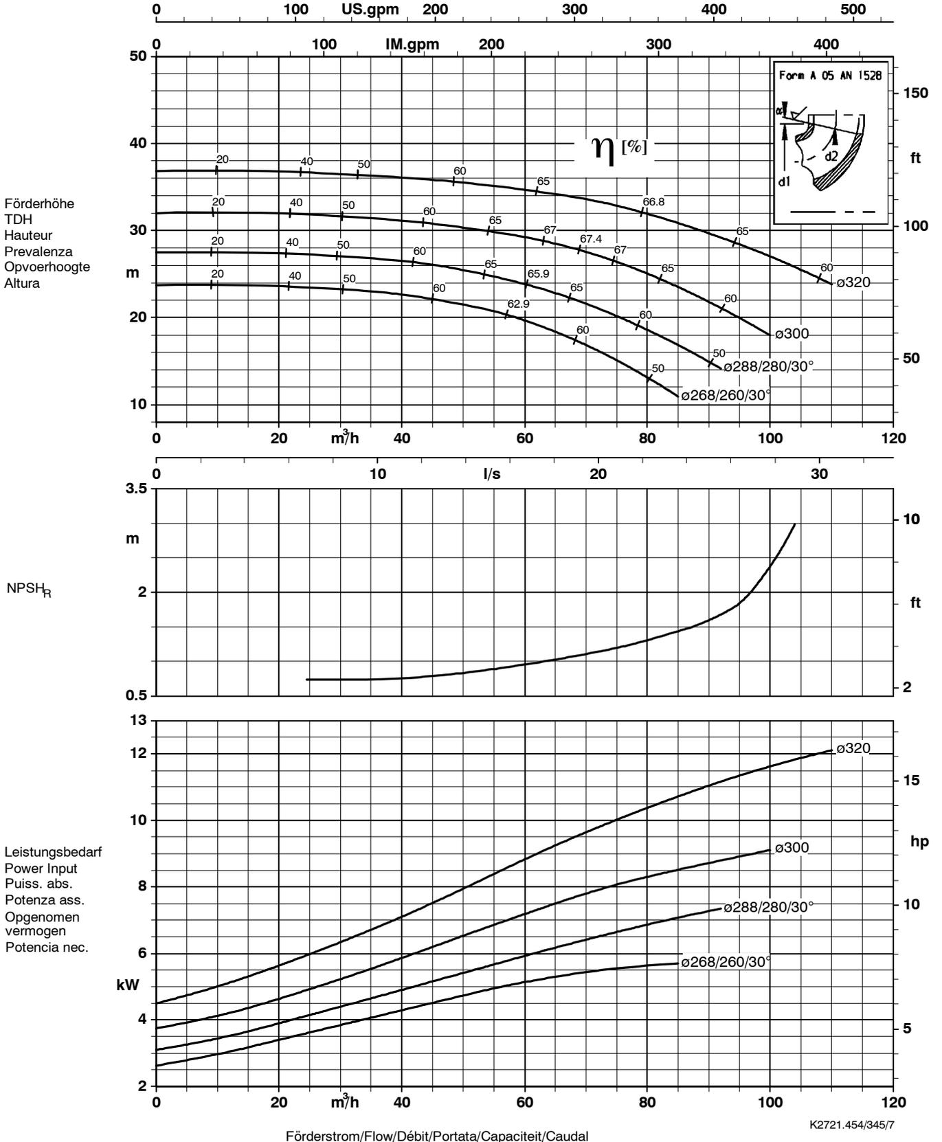
Lauftradaustrittsbreite/Impeller outlet width/Largeur à la sortie de la roue 14 mm
