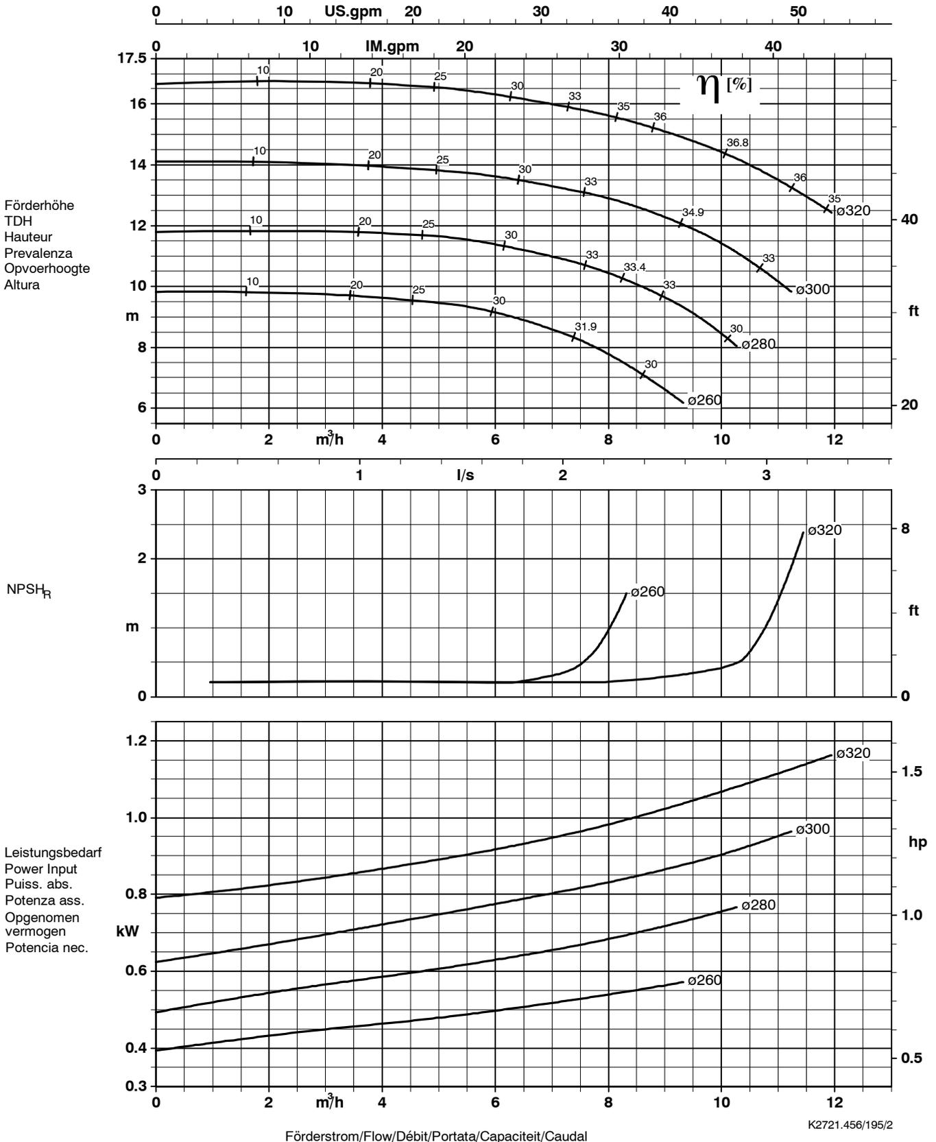
Laufradaustrittsbreite/Impeller outlet width/Largeur à la sortie de la roue 8 mm
