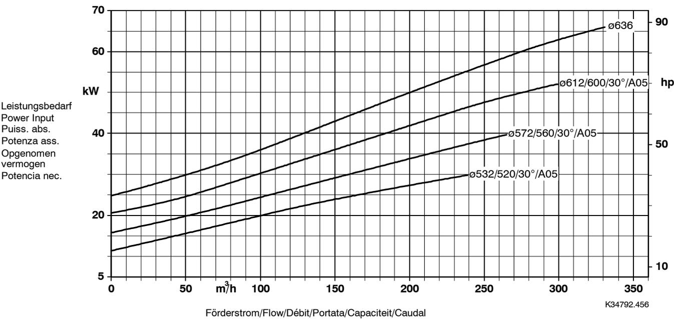
Laufradaustrittsbreite/Impeller outlet width/Largeur à la sortie de la roue 21 mm
